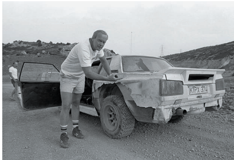
86年4月末のギリシャテスト。ベース車の上に被せられたFRP製フェンダーの様子がよく分かる。しかし、リヤフェンダーの材質変更は、結局FISAが認可しなかった。
