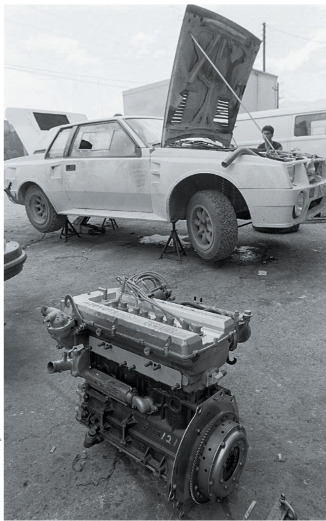
同じく86年4月末のギリシャテストでの894B。396Eエンジンの特徴である4連スロットルバルブはこの時に初めてテストされた。この時のユニットは試作品だったが、5月半ばに仕様変更が正式に決まった後、FISAの査察まで1カ月足らずという段階で、日本サイドがインタークマニホールド、サージタンク、スロットルボディなどを設計からやり直した。
