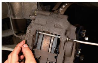
パッドピンとクロススプリング、クリップを取り付ける。マイナスドライバーでパッドピンを回転させて抜け止めクリップを穴に固定しよう。
