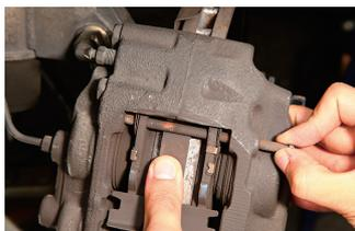
ブレーキパッドを固定しているパッドピンを引き抜く。十字のプレート飛ばさないように注意。
