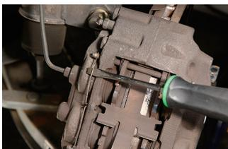
パッドピンが抜けないように固定しているクリップをマイナスドライバーやプライヤーを使ってはずす。
