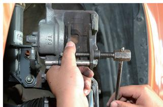
専用のピストン戻しツールを使って、キャリパーのピストンを押し戻してやる。
